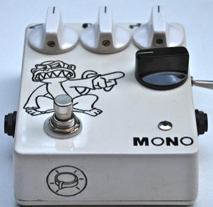
Il **Mono Fuzz**, è un fuzz dalla linea accattivante e aggressiva. Il primo potenziometro in alto a sinistra serve per controllare il volume del segnale in uscita, il potenziometro al centro serve per il controllo del tono, il potenziometro a destra è una sorta di gate che serve per creare effetti unici; il potenziometro nero, invece, controlla il grado di saturazione del segnale. Lo switch laterale abilita un filtro "passa alto" con due frequenze di taglio.
