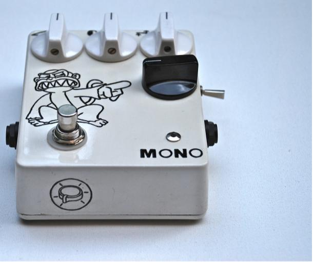
Il **Mono Fuzz**, è un fuzz dalla linea accattivante e aggressiva. Il primo potenziometro in alto a sinistra serve per controllare il volume del segnale in uscita, il potenziometro al centro serve per il controllo del tono, il potenziometro a destra è una sorta di gate che serve per creare effetti unici; il potenziometro nero, invece, controlla il grado di saturazione del segnale. Lo switch laterale abilita un filtro "passa alto" con due frequenze di taglio.
